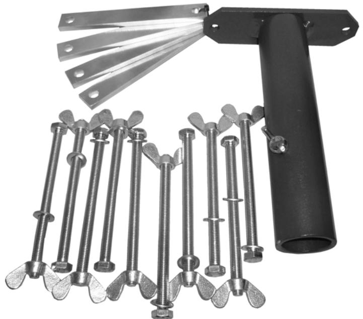
Nach dem auspacken hat man den Alubogen, den Stativaufsatz, 4 Bodenbleche und 10 Schrauben mit Unterlegescheiben und Flügelmuttern in den Händen. Die Schrauben werden von oben in den Fächer eingeschraubt. Dabei ist zu beachten, dass die Unterlegscheibe auf der Oberseite zwischen Fächer und Schraubenkopf ist.
